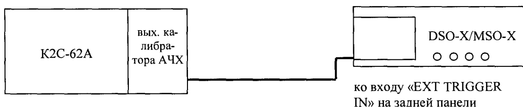
Рисунок 5 - Схема определения минимального уровня синхронизации от входа внешнего запуска
