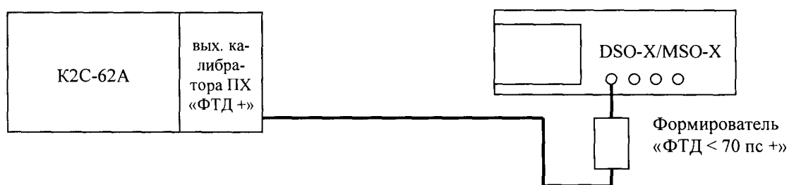
Рисунок 3 – Схема определения полосы пропускания
